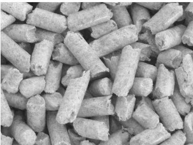
Abb. 17 – Hochwertige Holzpellets – Weißpellets ohne Schwarzkpunkte (Rinde)
