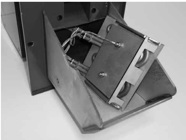
Abb. 3 - Demontierte Platte mit Glühspiralen
