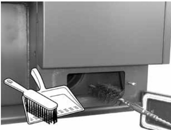
Vorführung der Reinigung des Rauchkanals mit Drahtbürste.
